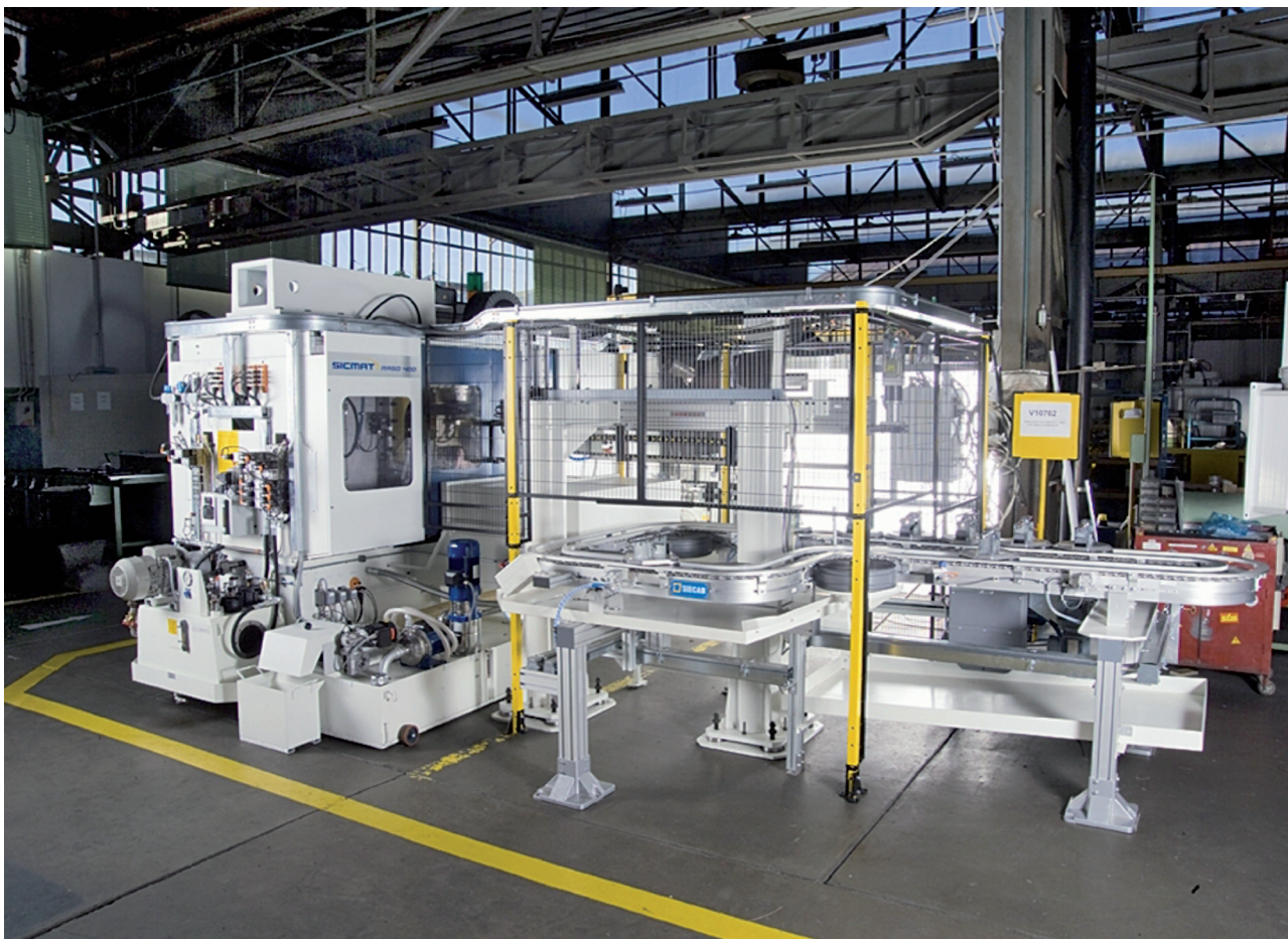
Vista frontale della Rasatura serie 400 Cnc con caricatore ad anello con riciccolo di pallet.
